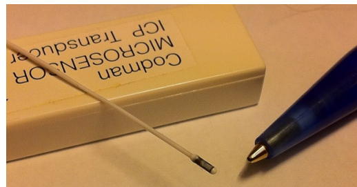
Figur 2: Kateterspetsgivare för intrakraniellt tryck.
